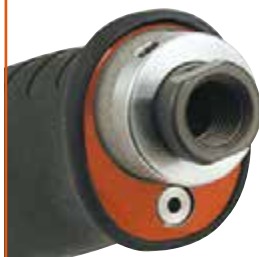
Standard levegőjel-indikátoros szerszámkikapcsolás a Cleco TVP hibamentesítő rendszerrel való használatra
