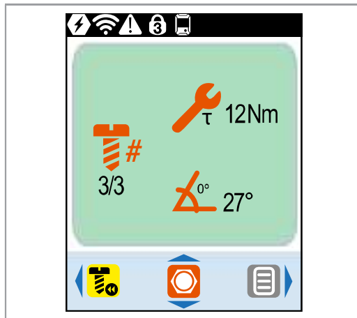
Rys. 3-2: Podgląd procesu w trybie mPro bez zewnętrznego wyboru GP/procedury
