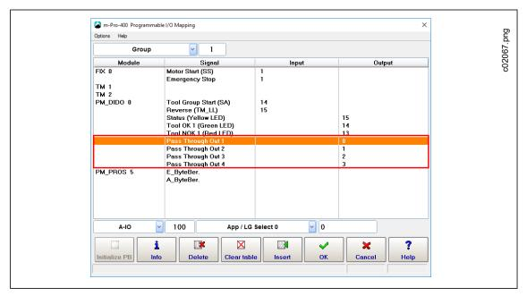
Fig. 10-15: Trasys - Set up Programmable I/O's
